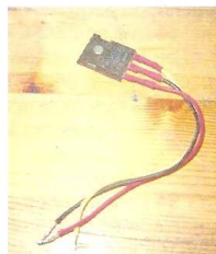
Fig. 4: Rectificador que integra dos diodos en una única cápsula.
