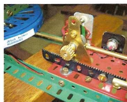
Fig. 4: Otro ejemplo de montaje. Se puede apreciar el muñón especial utilizado para fijar el potenciómetro.
